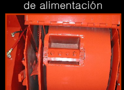
Sistema de impulsión de aire, 8 hojas
