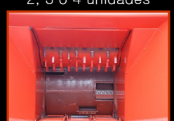
Distribución escalonada de las cuchillas
